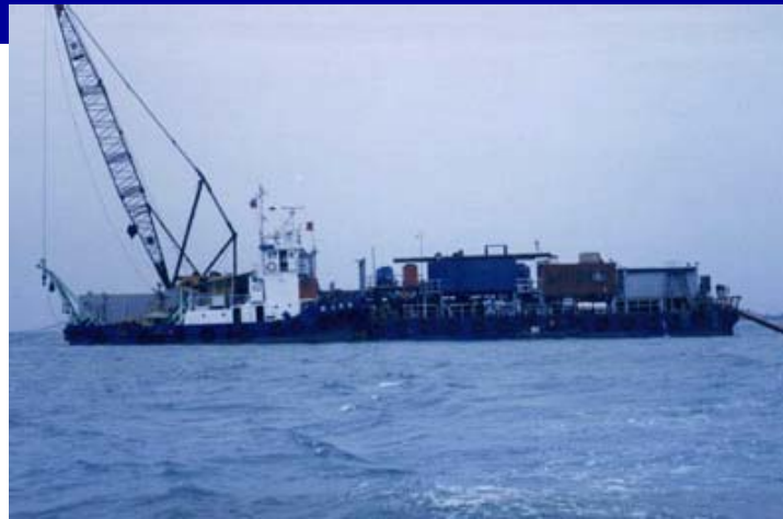
Barge de pose de pipe PEHD au large des îles Kin Men
